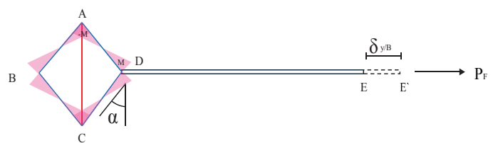
図6 剛接合化による曲げモーメント分布
