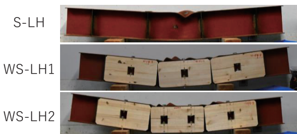
写真2 軽量H形鋼梁・合成構造梁の終局状態
