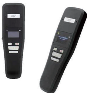
図2 提案システムで用いたRFIDリーダー
