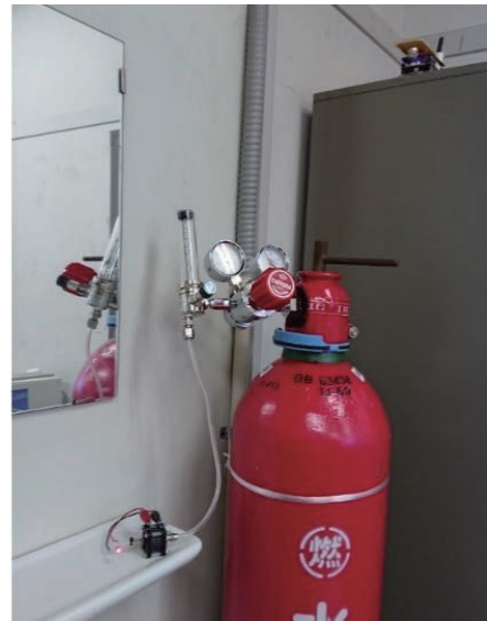
図17 水素センサーを用いて、部屋中の水素濃度 (ppm)、温度、湿度、気圧等を15分ごとにモニター中の写真 (場所 新1号館408号室)
