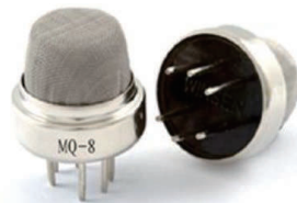
図11 水素センサーMQ-8の写真 16)
