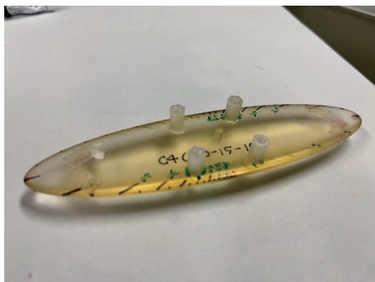
Fig.5. 支柱となる六角ナットを取り付けたアクリル製セルト
