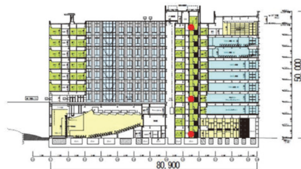
図2 講義棟 Nexus21の立面 (断面) 上の強震計設置位置 (赤丸3箇所)
