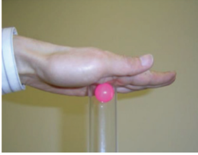
図1 円筒内でスーパーボールを転がして手に当たった後、円筒を立てたところ。スーパーボールが手にくっついて落ちてこなくなる。
