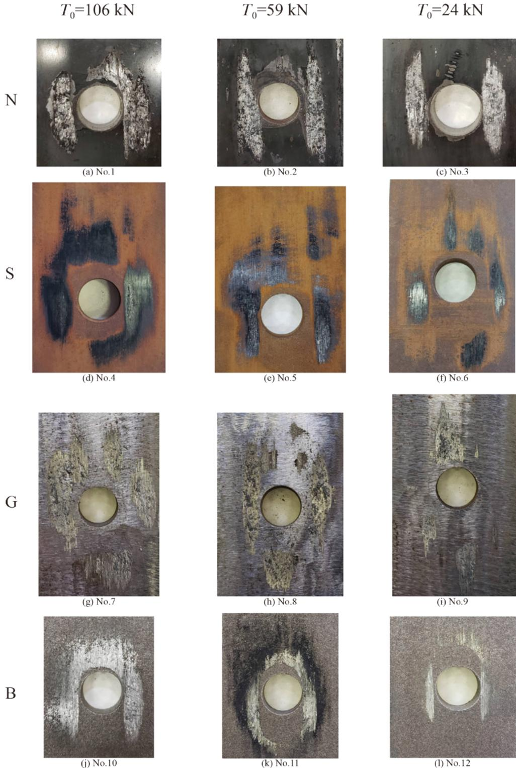
写真1 実験後の添え板の様子
