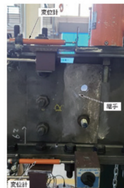
写真1 継手に取り付けられた変位計の様子
