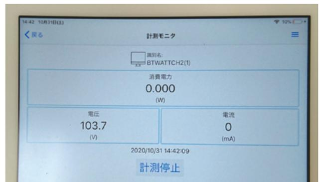
Fig. 28 Arduino-MQ131-driver を用いたオゾン濃度測定オゾンセンサーのテスト回路 (Fig. 19 参照) を用いて製作したオゾンセンサーの消費電力を、ワットチェッカーを用いて立ち下り後の計測中の写真
