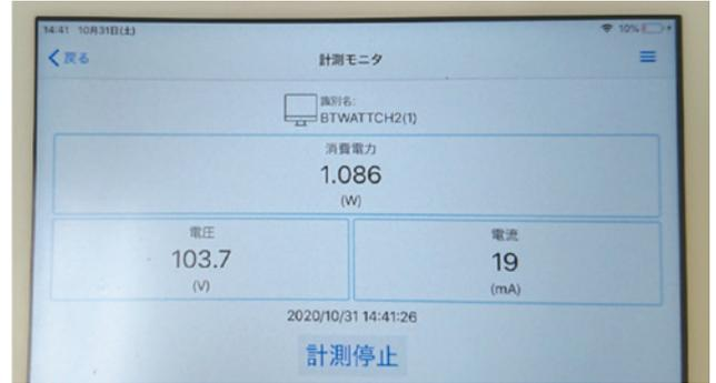
Fig. 26 Arduino-MQ131-driver を用いたオゾン濃度測定オゾンセンサーのテスト回路 (Fig. 19 参照) を用いて製作したオゾンセンサーの消費電力を、ワットチェッカーを用いて立ち上がりの計測中の写真
