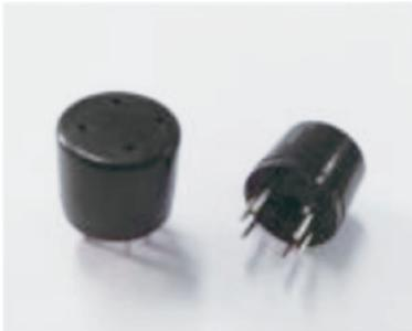
Fig. 2 オゾンセンサー (MQ131) の写真
