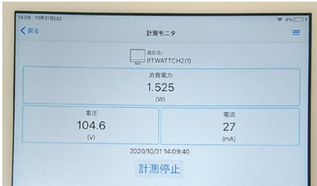
Fig. 24 オゾンセンサーのテスト回路 (Fig. 3 参照) を用いて製作したオゾンセンサーの消費電力を、ワットチェッカーを用いて計測中の写真
