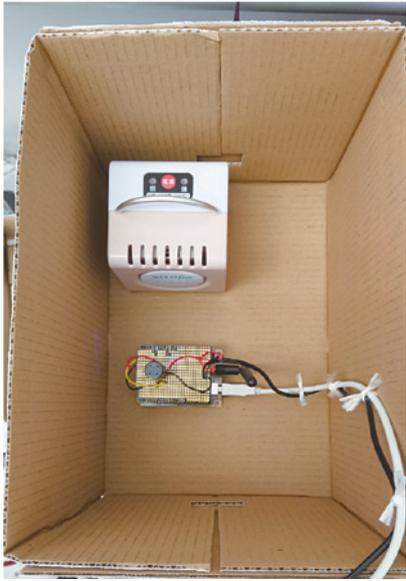
Fig. 13 オゾン濃度測定時のオゾン発生装置と測定装置の配置写真
