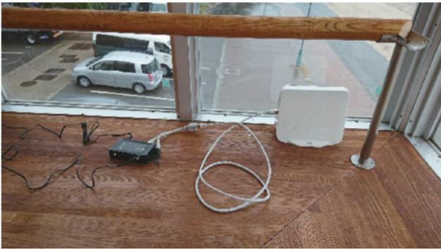
Fig. 33 うみのす 2F に設置した Sigfox の Access Station Micro <sup>10)</sup>
