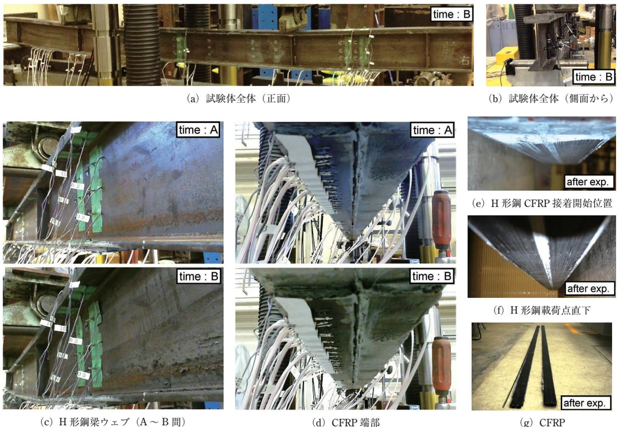
図16 試験体の写真 (CFRP4/3500 fw)
