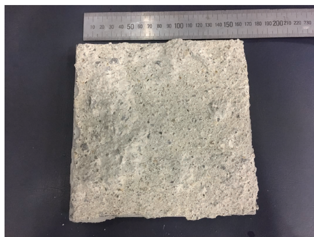
写真1 水平変位拘束材の破壊状態
