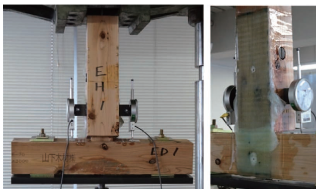
写真2 破壊性状 ほぼぞ部抜け (左), 樹脂部剥落初期 (右)
