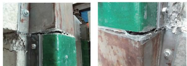
図3-2 補強部破壊状況
