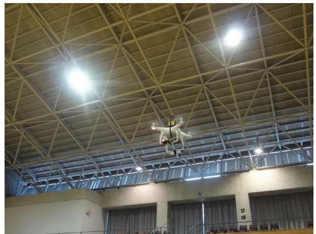
図8 ドローンを用いたLED照明の輝度測定風景
