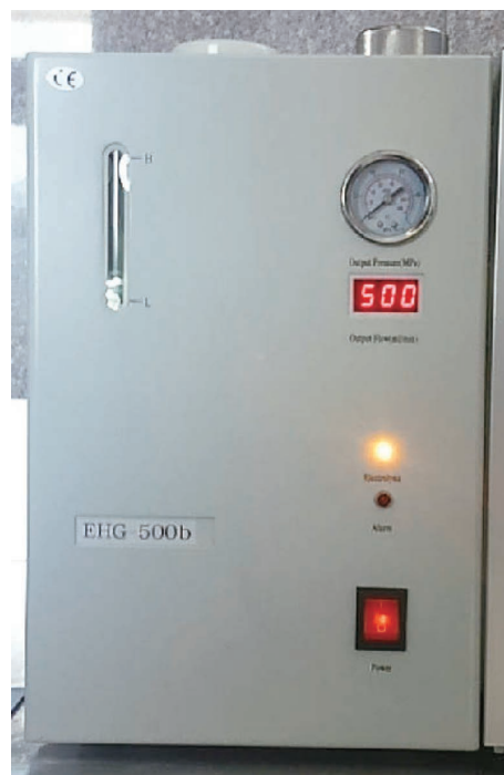
図11 水素発生装置
