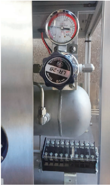
図13 燃料電池供給用水素ガス圧を測定するための圧力ゲージ
