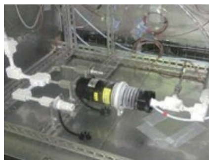
図40 水素充填時の充填ノズル水結・固着試験
