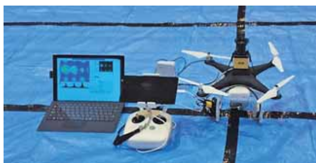
Fig. 20 広島工業大学高等学校のアリーナの直視輝度を測定する機材（左から制御用パソコン，ドローンコントロール装置，ドローン）
