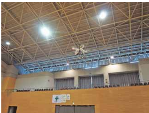
Fig. 23 ドローンを用いた LED 照明の輝度測定風景
