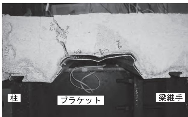
図10 梁端付近ひび割れ
