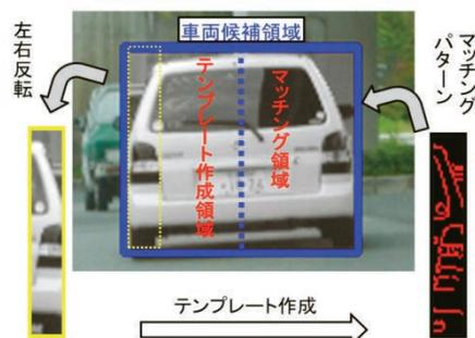
図3.5 エッジによる車両検出の概念
