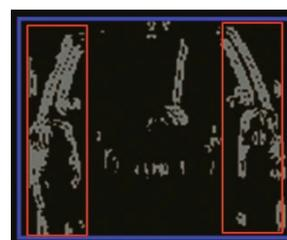
図3.4 車両の垂直エッジ画像例
