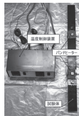
写真2 温度制御装置
