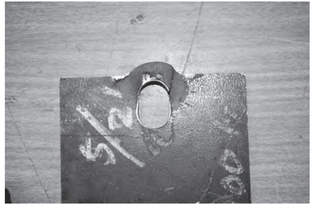
写真3 端抜け破断した中板
