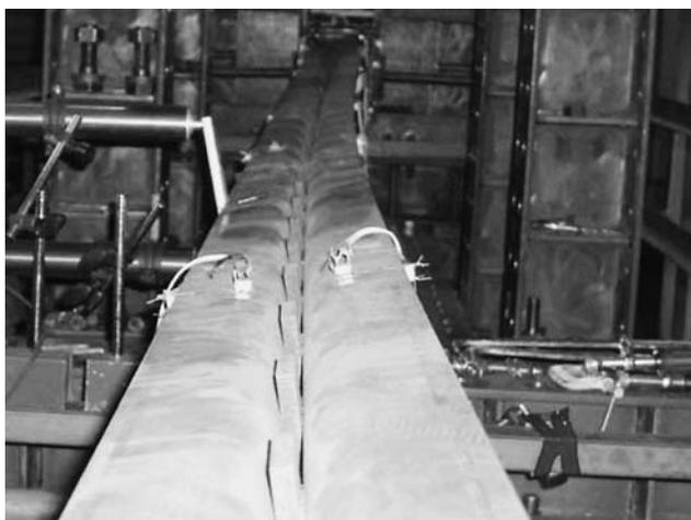
写真1 圧縮フランジの横座屈変形
