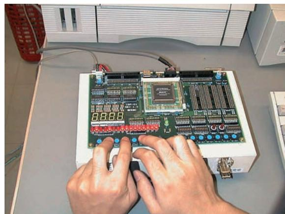
図5 ISPプログラマ&チェッカを用いたFPGAへの書き込みおよび論理検証
