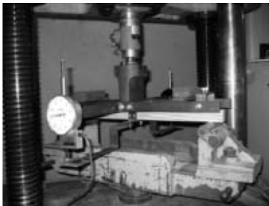
写真3 曲げ破壊試験
