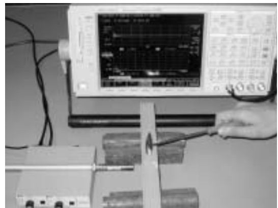
写真5 横振動によるヤング係数測定状況
