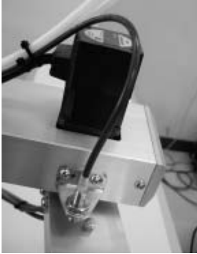
磁気抵抗素子によるリンク 2 の位置決め
