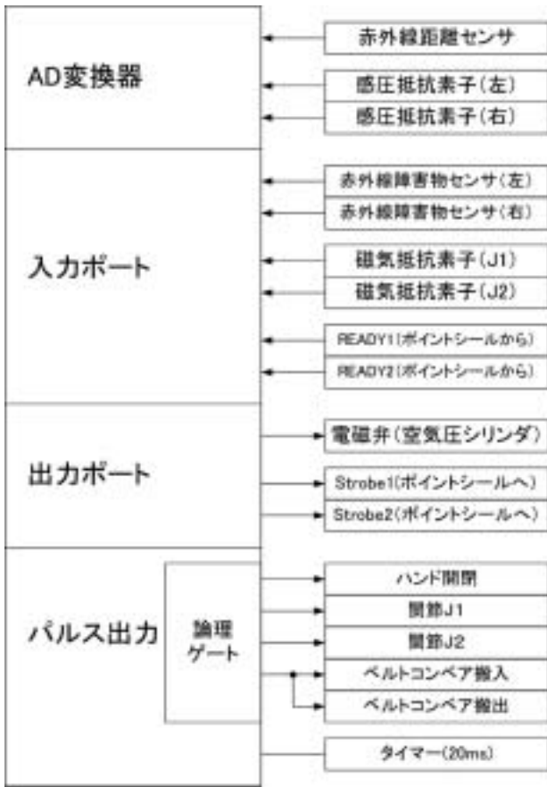
図3 H8 マイコンによる計測・制御装置の構成
