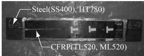
写真4 試験体形状
