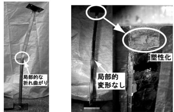
写真3 試験後の残留変形状態
