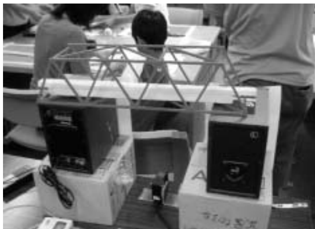
図3 錘を載せてのトラス橋の模型のたわみの実演
