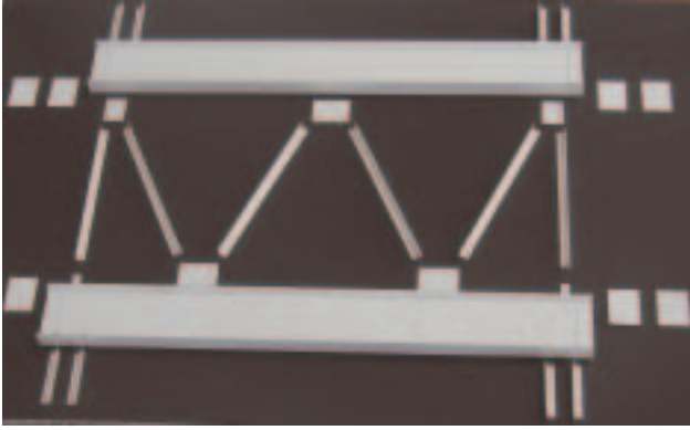
写真-8 橋梁構造模型
