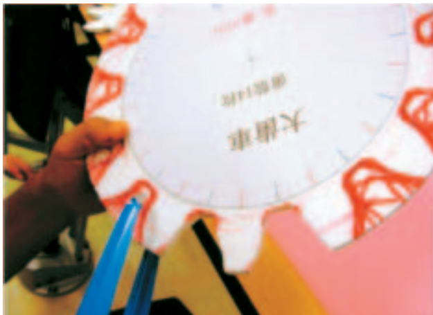
図9 熱線ワイヤにより歯車を切り出す
