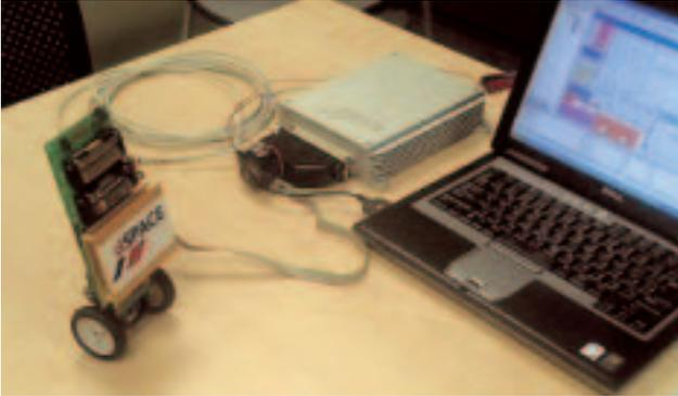
Fig.6 dspace 製制御ユニットを用いて制御中の Puppy
