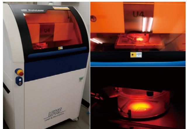
図 7 プリント基板のレーザー加工装置 (The LPKF ProtoLaser U4、本体 (左)、レーザー加工中 (右上 (全体像)、右下 (加工部分の拡大))<sup>[11]</sup>
