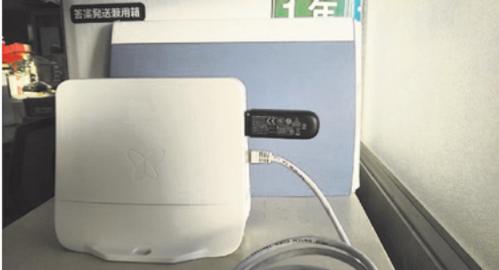
Fig. 32 広島県立熊野高校に設置したSigfoxのAccess Station Micro 14)
