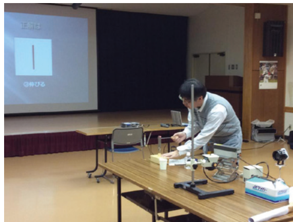
図3 おんさを強く叩いたときに現れる縦長のリサージュ図形の確認の様子。
