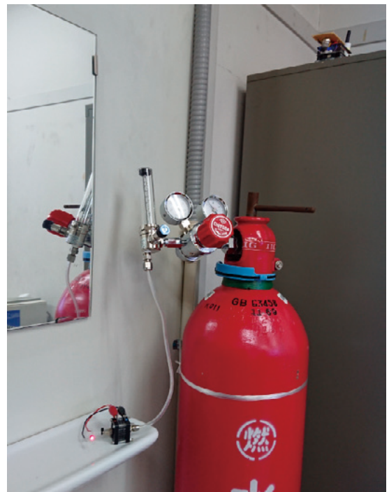
Fig. 7 新1号館408号室への水素センサー (MQ-8) および水素の初歩的な教育システムの写真
