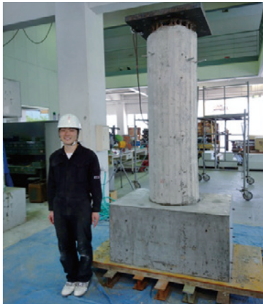
(b) 実サイズ断面の試験体 (片持ち柱) 写真13 コンクリート系部材の試験体
