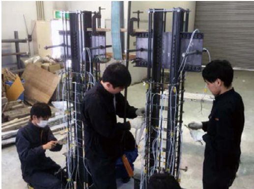
(a) 縮小サイズ試験体の製作
