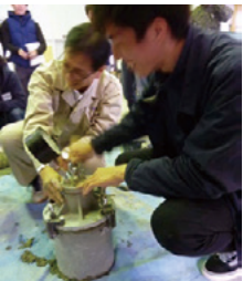
写真6 コンクリートの受け入れ検査と打込み
