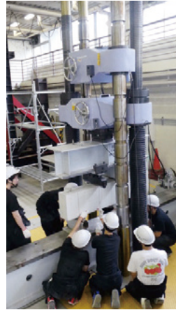
写真2 大型載荷装置
