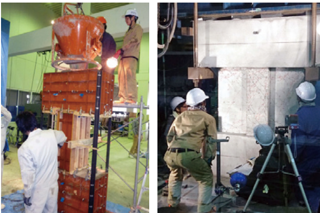
写真14 試験体製作および荷重実験の様子
