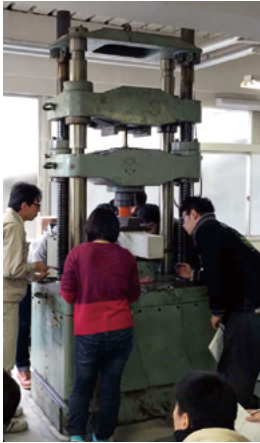
写真1 小型載荷装置
