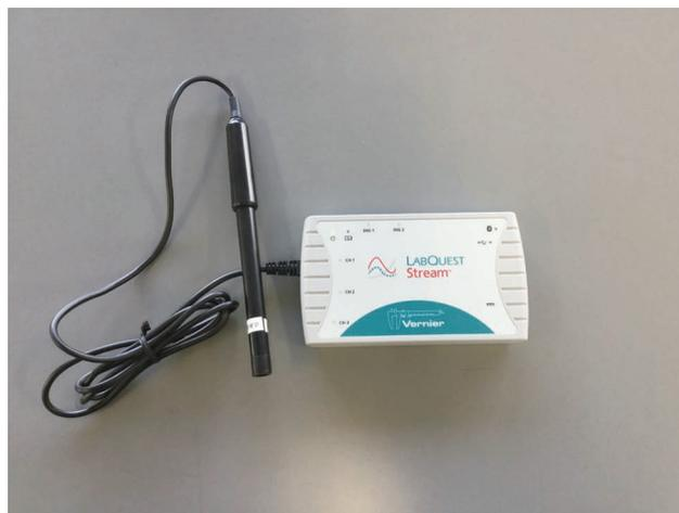
図1 LabQuest Stream と音圧センサー
