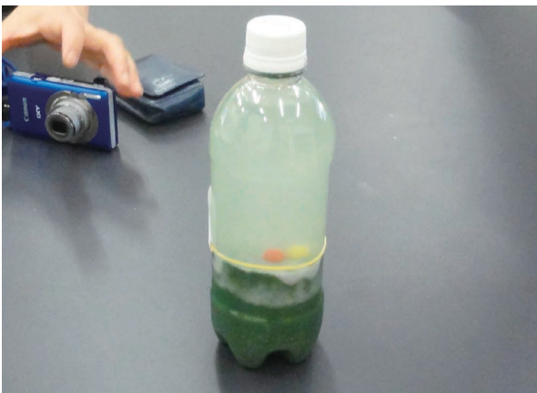
図5 振動を与えた後の液状化の体験装置
