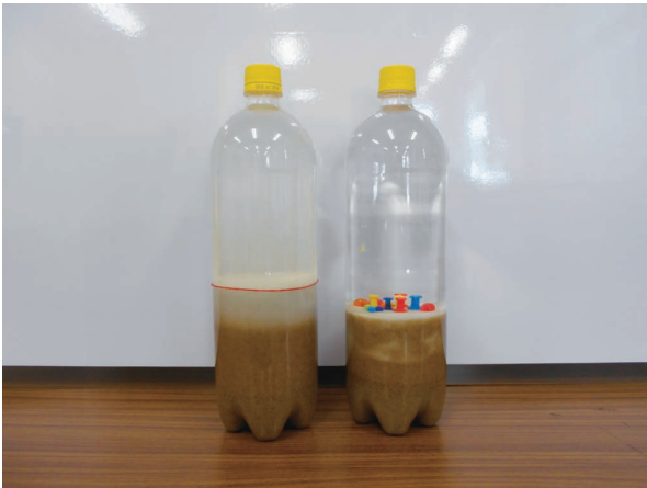
図7 今回新たに作成した液状化の体験装置 左：振動を加える前 右：振動を加えた後
