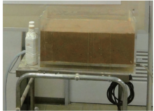
図3 本学本学科の液状化の再現装置
