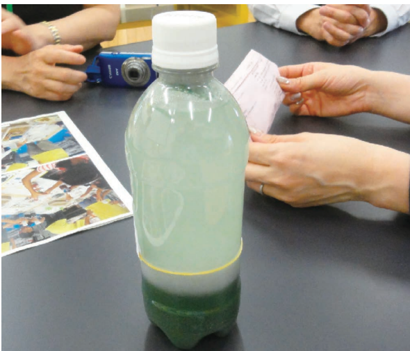
図4 振動を与える前の液状化の体験装置
