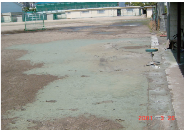
図2 芸予地震による噴砂の事例
