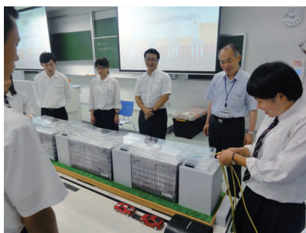
図5 実習1 PC橋の模型に引っ張り力を加える様子
