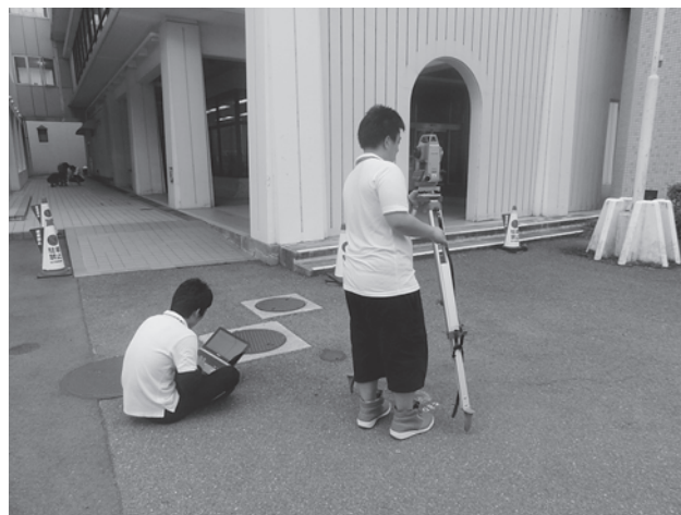
図9 測量地点で直接データ入力を行う
